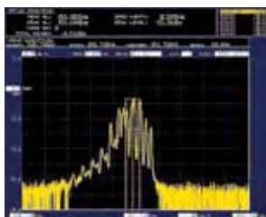
多模光纤(62.5/125mm)测量时的波形 (850nm)
