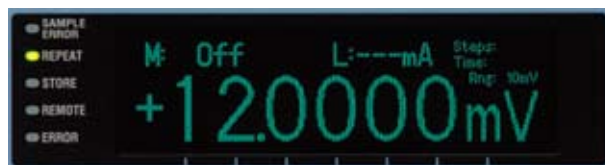
以±120,000显示计数、最小100nV步进的高分辨率进行输出
