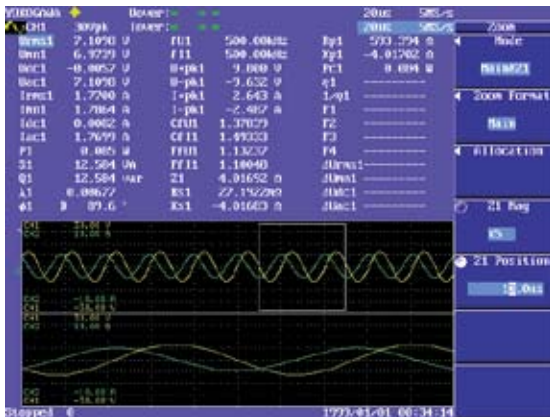
电容器高频驱动（500kHz）过程中的损耗测量实例
