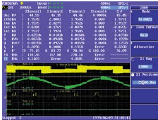
利用图像放大功能确定低转速运行时是否全部获得脉冲波形的实例
