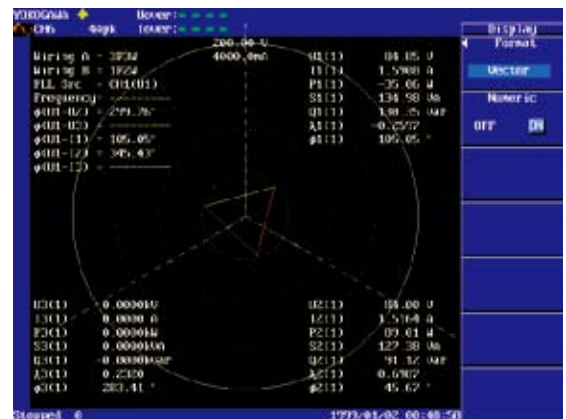
变频器输出基波矢量显示实例。
